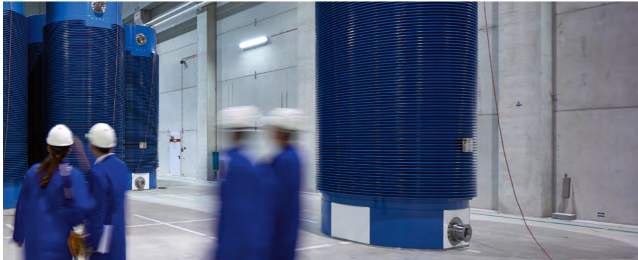
Mitarbeiter*innen der BGZ inspizieren CASTOR-Behälter vom Typ V/19 in einem Zwischenlager
